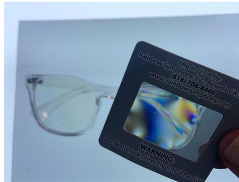
Die Doppelbrechung hängt von Wellenlänge, Materialdicke und Druck ab und erzeugt beim Durchgang von Licht ungewöhnliche Polarisationen. Diese Muster sind jedoch mit bloßem Auge nicht erkennbar. Um sie sichtbar zu machen, muss man ein einfaches Instrument namens Polariskop bauen.
